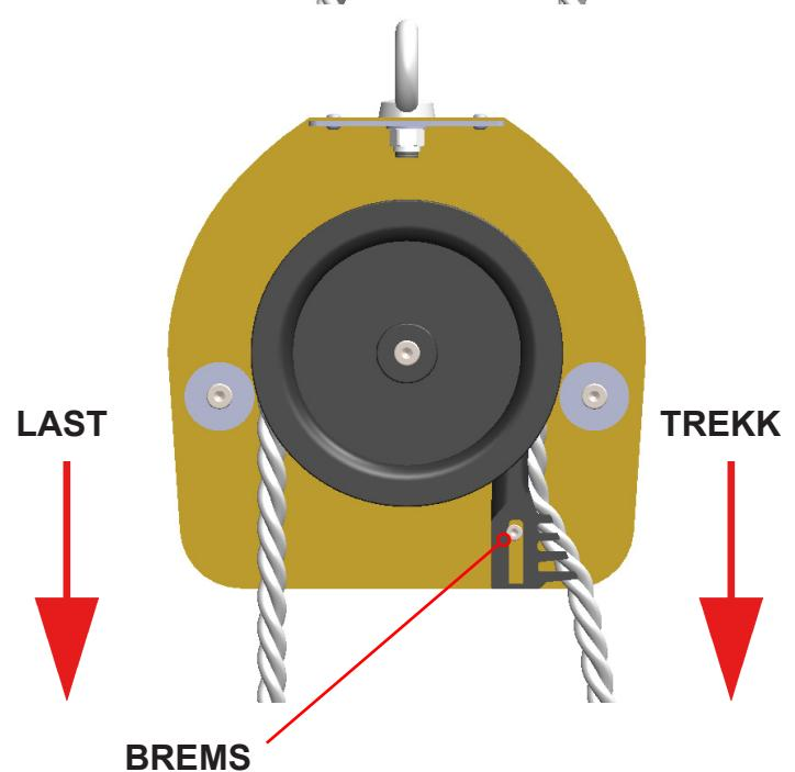
Når lasten låres ned, må hastigheten kontrolleres. Lasten senkes i rolig tempo. Ved for høy hastighet, kan Heisehjul eller tau ta skade.
